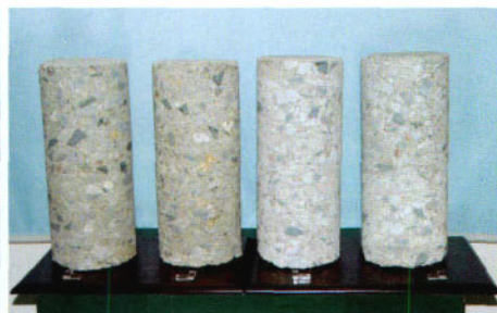
④ 江西景婺黄(常)高速公路CP2标水稳层超厚度530mm大宽度12m一次性摊铺取芯
