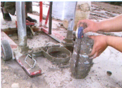
110国道包头市协力气至沙尔沁段公路的改建工程大厚度摊铺取芯样品
